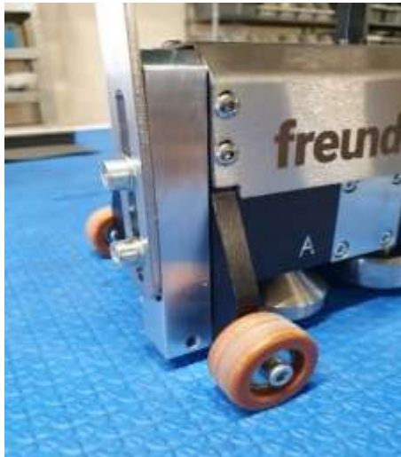
Stabilere Halterung des Akku-Schraubers Verstellbare Räder für 25, 32 und 38 mm
